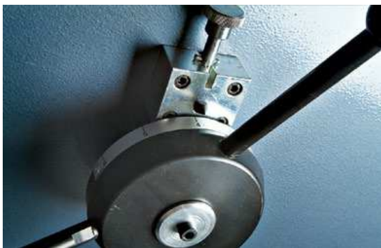
Podešavanje nožnog zazora u jednoj tački
