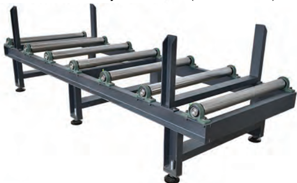
3 m motoros görgősor Motorni valjčasti sto 3m (BMSY 810 C)
