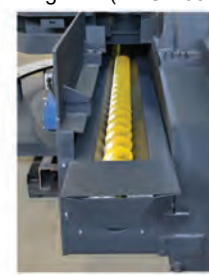
Forgács kihordó Uredjaj za odstranjivanje strugotine (BMSY 650 DG)
