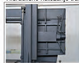
Forgács kihordó Uredjaj za odstranjivanje strugotine (BMSY 650 DG)
