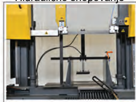
Forgács kihordó Uredjaj za odstranjivanje strugotine (BMSY 1110C)
