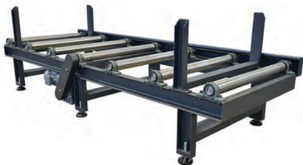
3 m motoros görgősor Motorni valjčasti sto 3m (BMSY 810 C)
